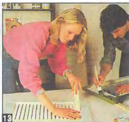
13 Загрунтовав поверхности дверец, их покрывают лаком, предварительно обклеив лентой защищаемые места.
