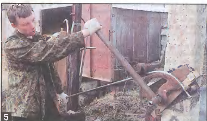
5 Процесс изготовления поручня. Нажимая одной рукой на рычаг, одновременно второй рукой надавливаем на конец трубки.
