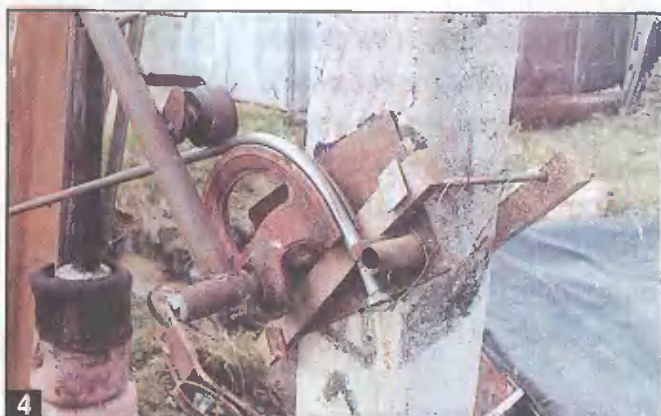
4 Приспособление для гнутья укреплено на столбе с частично загнутой трубкой.
