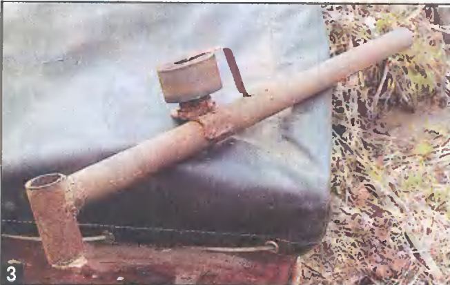
3 Изгибающий рычаг с обкатным роликом.
