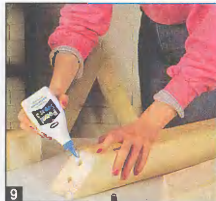
9 Клей наносят как на контактирующие поверхности, так и на шканты.
