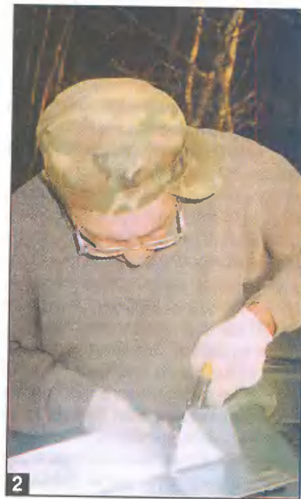
Лишнюю часть бортика бокового листа отрезают ножницами.
